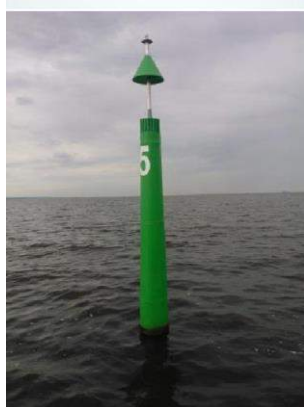
Фонарь ФСН-03МР-М с автономным питанием на бую №5 (тип Н-400/6) подходящего канала Морской Резиденции Президента РФ. п. Стрельна
