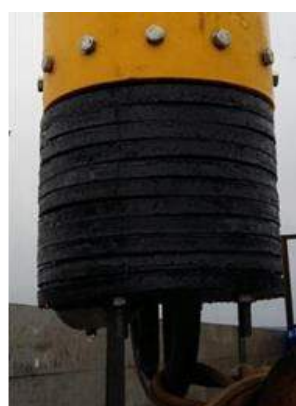
Жестко закрепленные противовесы (буй HT400/7ice)
